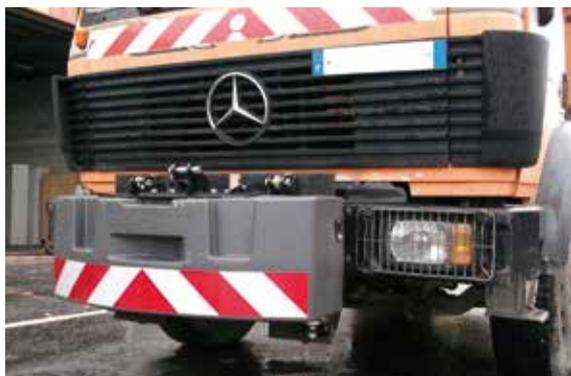
*El gancho está situado en el centro de gravedad para suspender la masa. Se utilizan dos conos para el centrado y 4 bridas abatibles sobre la placa SETRA para el bloqueo.*
