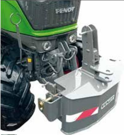
■ **LA INTERFAZ ESPECIAL FENDT PARA VITICULTORES** permite acercar la masa del tractor para reducir el voladizo delantero en el caso de cabeceras estrechas, facilitando la recogida de hileras de viñas con mayor facilidad. El montaje se realiza con los 4 ejes suministrados.
